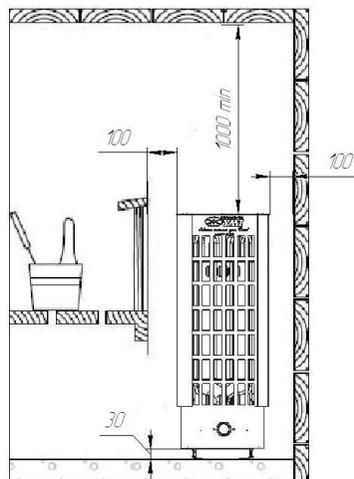
2. Установите каменку и выровняйте ее так, чтобы она стояла строго вертикально, с помощью регулируемых по высоте ножек.
